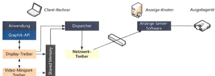
Abb. 1 Schematischer Aufbau der Kommunikation zwischen den verschiedenen Abstraktionsebenen einer Clusteranwendung zur Visualisierung
