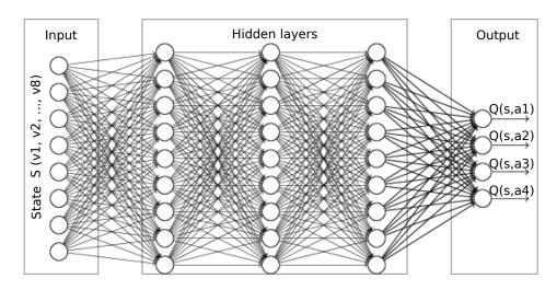
Figure 7: Example of the structure of a DQN.
