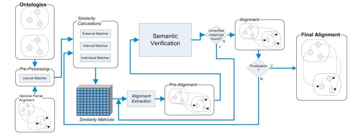
Fig. 2. ASMOV Block Diagram
