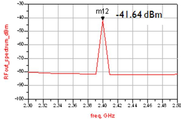
**Figure 73 LNA output spectrum**
