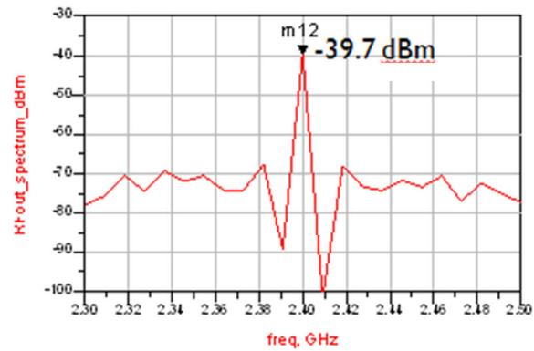
Figure 70 LNA output spectrum
