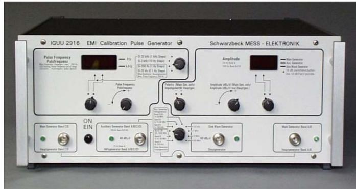
Fig. 2 CISPR pulse generator Schwarzbeck IGUU 2916.
