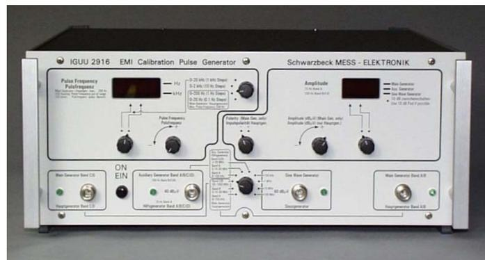
Fig. 2 CISPR pulse generator Schwarzbeck IGUU 2916.
