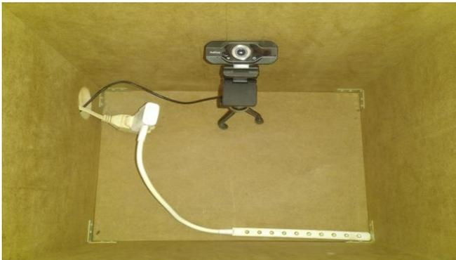
Fig. 5. Interior del sistema tangible, compuesto por una Cámara HD y una luz Led.
