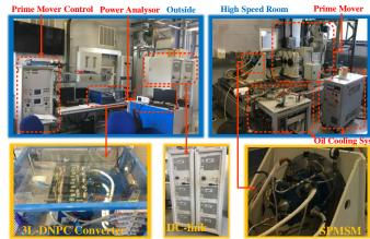
Fig. 23. ESG test rig setup
