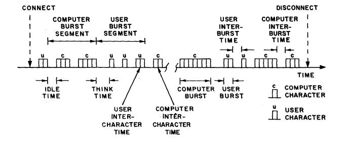
FIGURE I THE DATA STREAM MODEL
