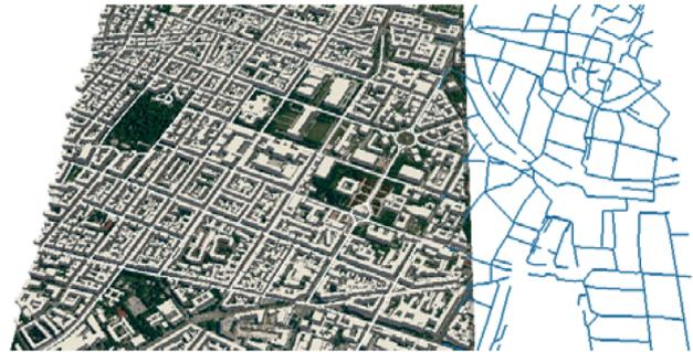
**Abbildung 3:** GIS-Modell der Münchner Innenstadt mit darunter liegender Kanalisation.
