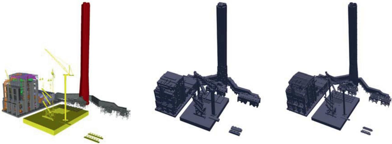
Abbildung 2: Kraftwerksgeometrie<sup>1</sup> (links) nach acht (Mitte) und zehn (rechts) Verfeinerungsschritten.
