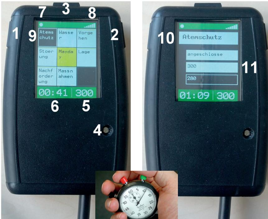
**Bild 1:** Handgerät des EmergencyMessengers. (links) Anzeige der 8 Kategorien von Routinemeldungen. (rechts) Auswahl einer Kategorie (hier: Atemschutz) mit zugeordneten Meldungen. Zum Vergleich eine Stopp-Uhr als Modell des Interaktionsschemas zur einhändigen Bedienung (unten).
